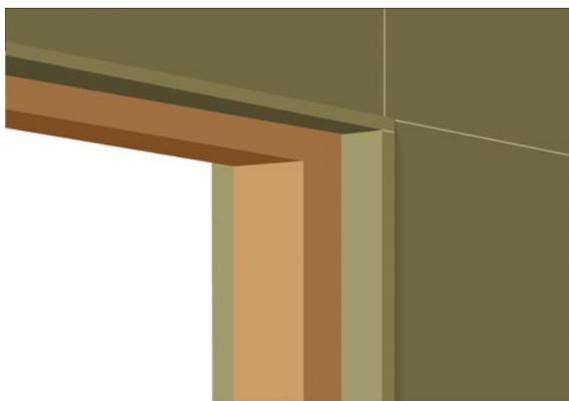
3. Механически прикрепите дверную или оконную коробку через изделие Caesarstone к стене внутри проема.
